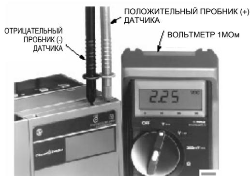
Рис. 22. Измерение сигнала пламени.
