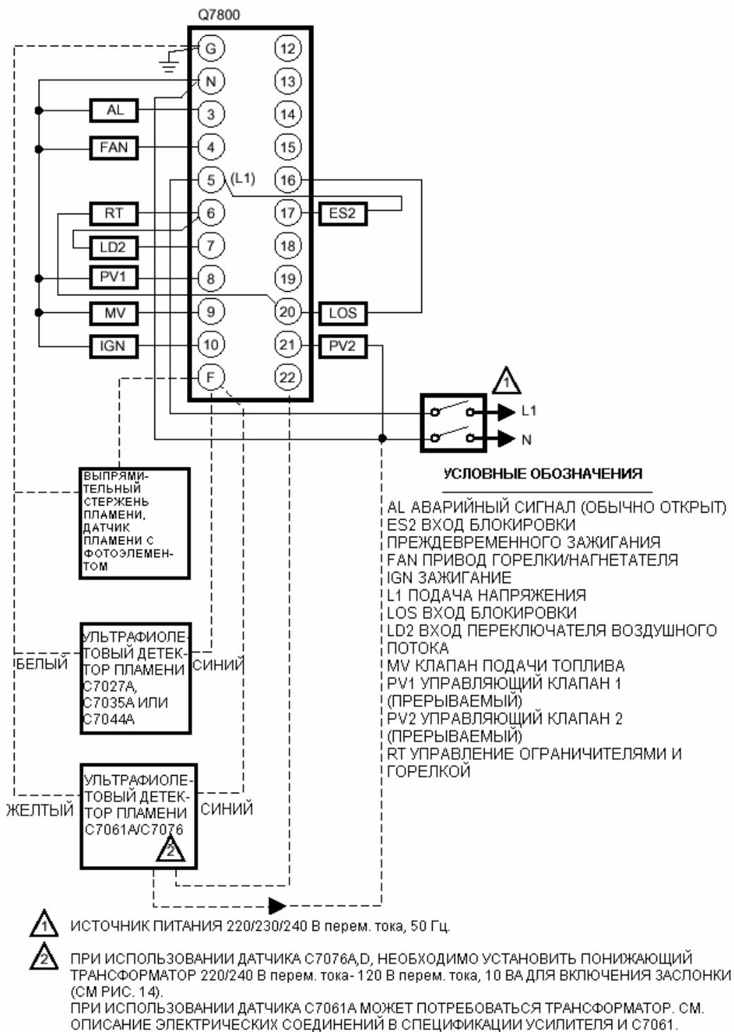
Рис. 4А. Схема электрических соединений EC7830A.
