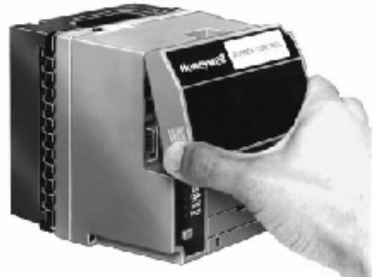
Рис. 10. Монтаж DATA CONTROLBUS MODULE™.
